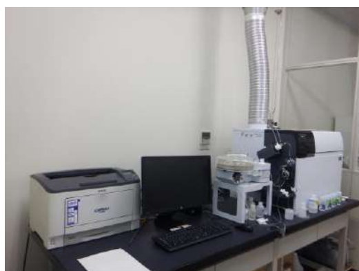
金属類を一斉分析する分析機器 (誘導結合プラズマ質量分析計)
